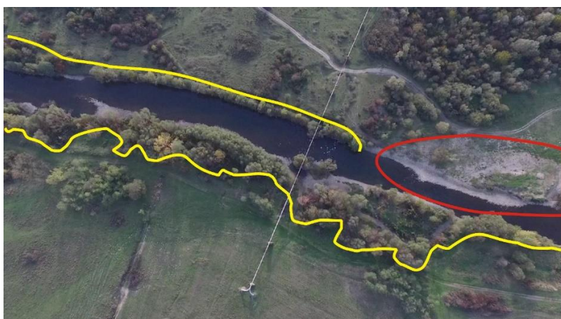
Figura 3 Aspect al unor zone ripariene (raul Timis) in dreptul punctului ce va fi traversat prin foraj dirijat – se observa si traversarea aeriana a unei conducte apartinand unei linii de transport distincte. Cu galben au fost marcate habitate ripariene ce se extind intre 1 si 8m – fata de 15m cat ar fi trebuit sa fie zona de protectie). Cu rosu a fost marcata o zona afectata de practici curente (adaparea animalelor, prelevare de balastru, zona de scaldare etc.) de la nivelul careia formatiunile ripariene au fost complet indepartate fiind inlocuite de formatiuni ruderaie
