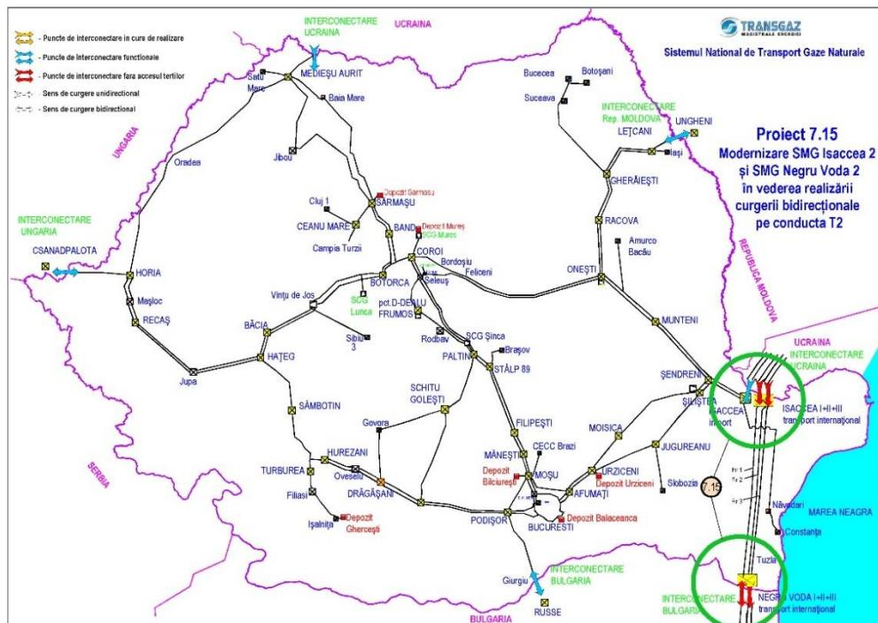
Figura 18 - Modernizare SMG Isaccea 2 și SMG Negru Vodă 2 în vederea realizării curgerii bidirectionale pe conducta T2
