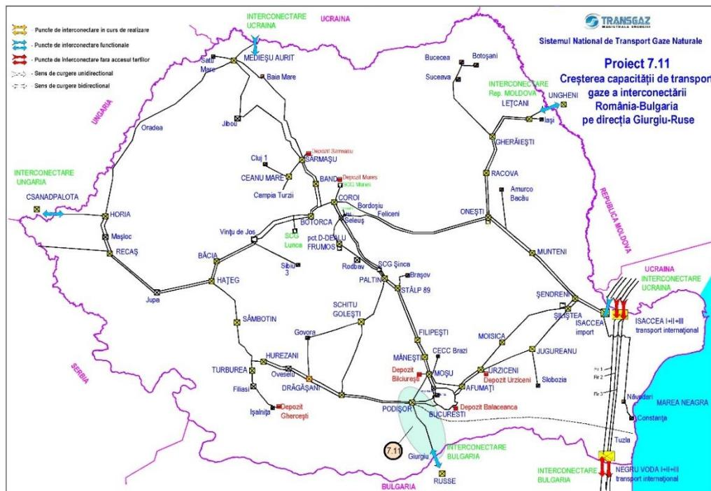
**Figura 16- Creșterea capacitatei de transport gaze naturale a interconectării România-Bulgaria pe direcția Giuraiu-Ruse**
