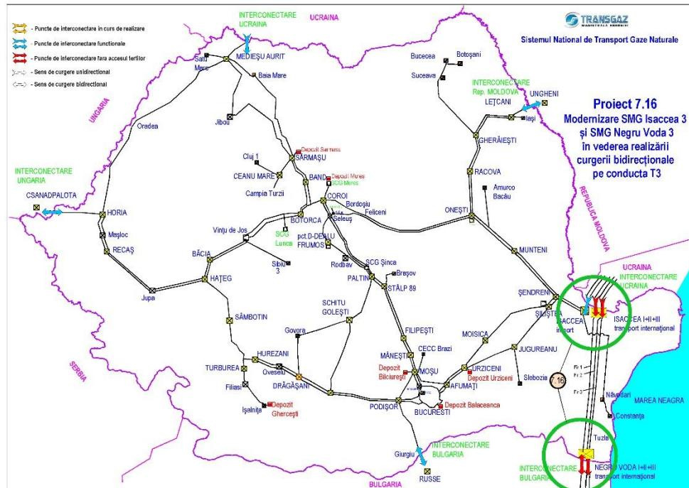
Figura 19- Modernizare SMG Isaccea 3 și SMG Negru Voda 3 în vederea realizării curgerii bidirectionale pe conducta T3
