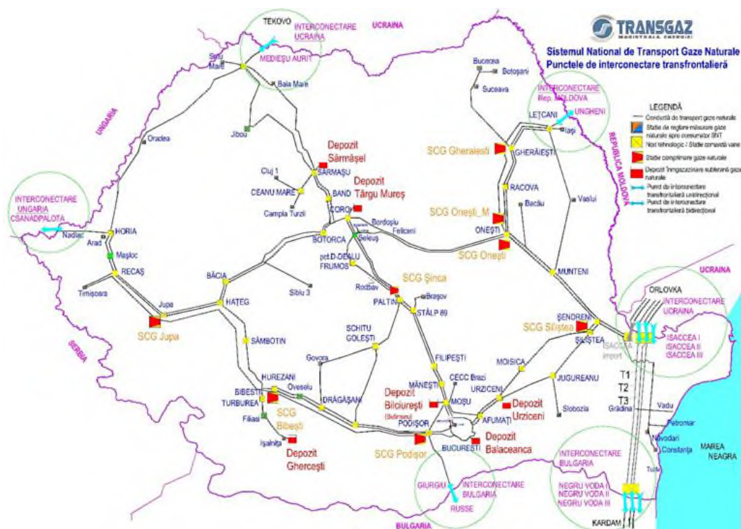
Figura 1- Harta Sistemului Național de Transport al Gazelor Naturale și punctele de interconectare transfrontalieră ale SNT
